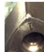
Обработка AISI 310 (SMG M4). При обработке фрезой Seco R220.88
