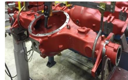
Обработка балки моста, материал - SS0717/GGG40, SMG: K4. Тест против Конкурента, где заказчик отметил большую плавность и меньше шума при работе фрезой Seco. Стойкость аналогична Конкуренту, но у конкурента 4 кромки против 8 у фрезы Seco.
