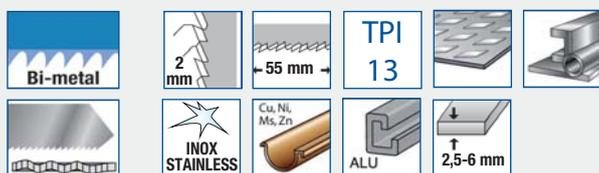
Dentado fresado y ondulado. Sierra flexible para aceros e inoxidable, metales no ferrosos y aluminio. Alto rendimiento.
